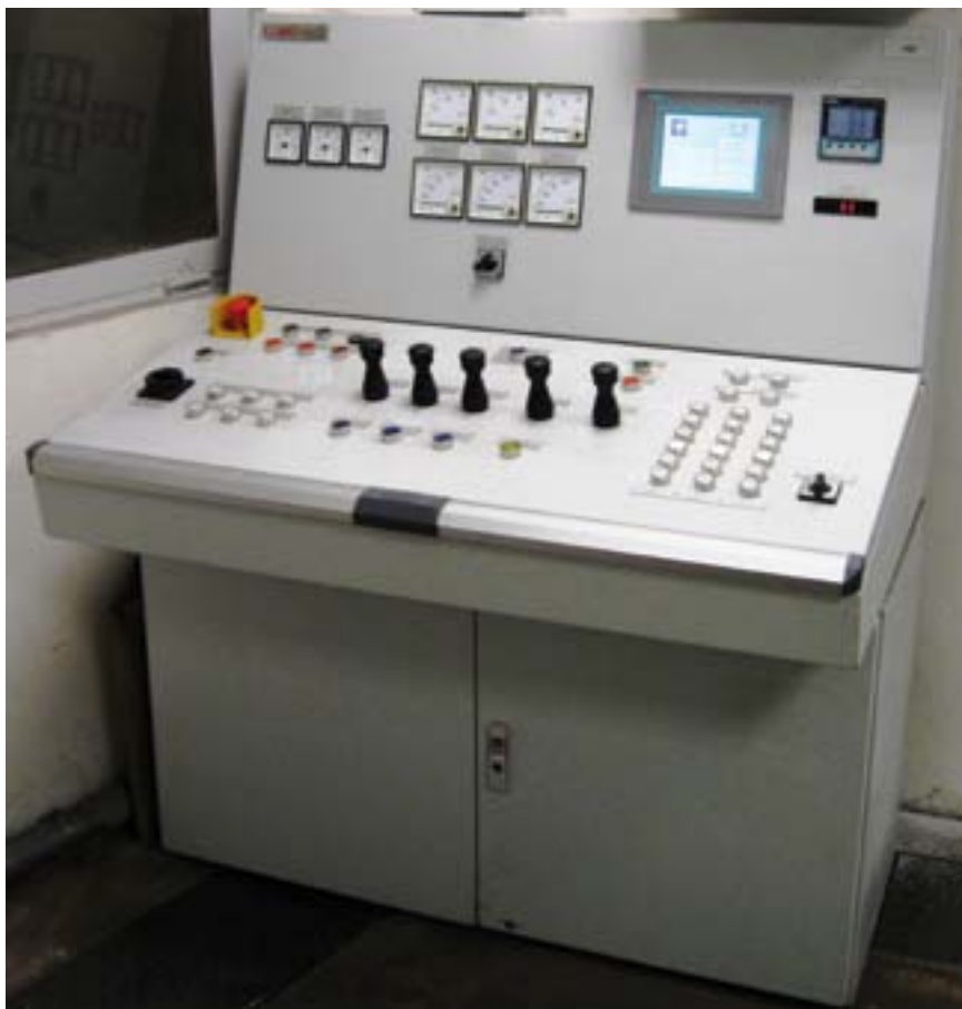
Bild 4: Das neue Hauptbedienpult.
