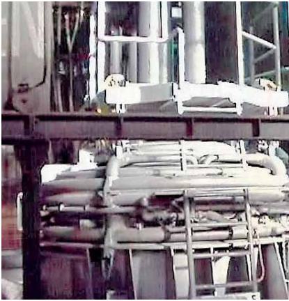
Bild 1: DS-Lichtbogenofen mit wasserführender Deckel- und Obergefäßzustellung, 3,5 S 2,4/4 Schnauze, Inbetriebnahme 2000 (Hersteller: SMS Demag).
